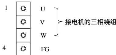
图 3 电机接线连接器座
