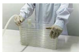
1. 连接软管到细胞工厂（需要另购PC接头或者转接器）
