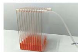
4. 灌完后立放，均分液体
