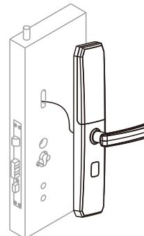
**!** 装配完成后检验下压把手为空转、无阻滞、反提把手可将主舌锁上锁。
