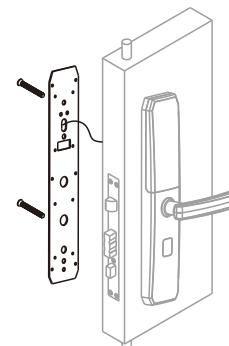
**!** 装配完成后检验下压把手为空转、无阻滞、反提把手可将主舌锁上锁。
