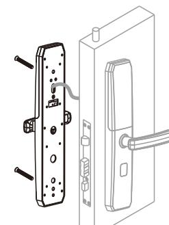
**!** 装配完成后检验下压把手为空转、无阻滞、反提把手可将主舌锁上锁。
