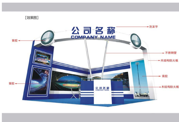
设计方案彩色效果图 ( 范本 ) -- 材质说明设计方案正立面图 ( 范本 ) -- 标明尺寸
