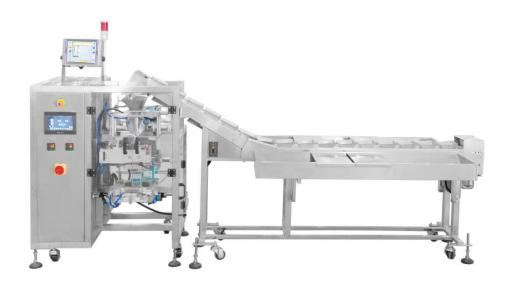
常用于包装易滑落的不规则形状的,不易称量、易自动包装的物料,尤其适用于中药饮片的包装,小剂量型半自动包装机常用于 3-50g 物料的包装。
