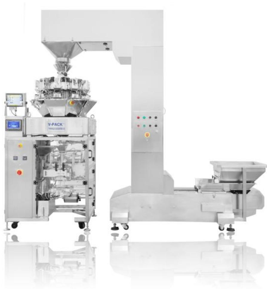
常用于包装易滑落的不规则物料，例如中药饮片小剂量(100g)。来料自动称重、自动封口成袋，真正实现
