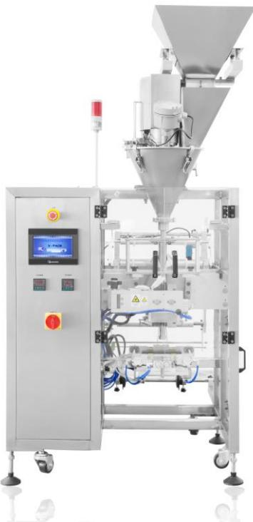
用途：本机适用于食品、医药、化工、农药、兽药等行业的**粉末状物料**的包装，本机可自动完成制袋、计量、充填、打印日期、封口部位打易斯口、计数等功能。
