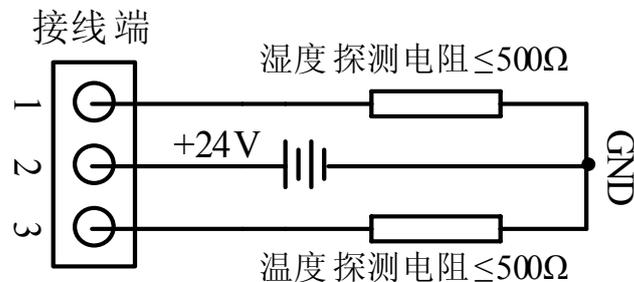
\*客户在接线时需认真检查输出信号与采集器或仪表端口的匹配，如变更信号方式时，必须将变送器供电电源断电，以免损坏。
